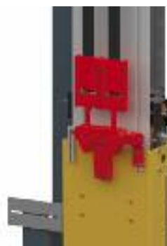
Wippe mit Schlaffriemen- / Riemenbruchabfrage Security switch for slack belt and belt failure
