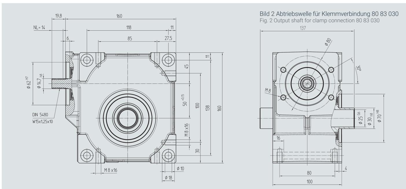
Bild 2 Abtriebswelle für Klemmverbindung 80 83 030
