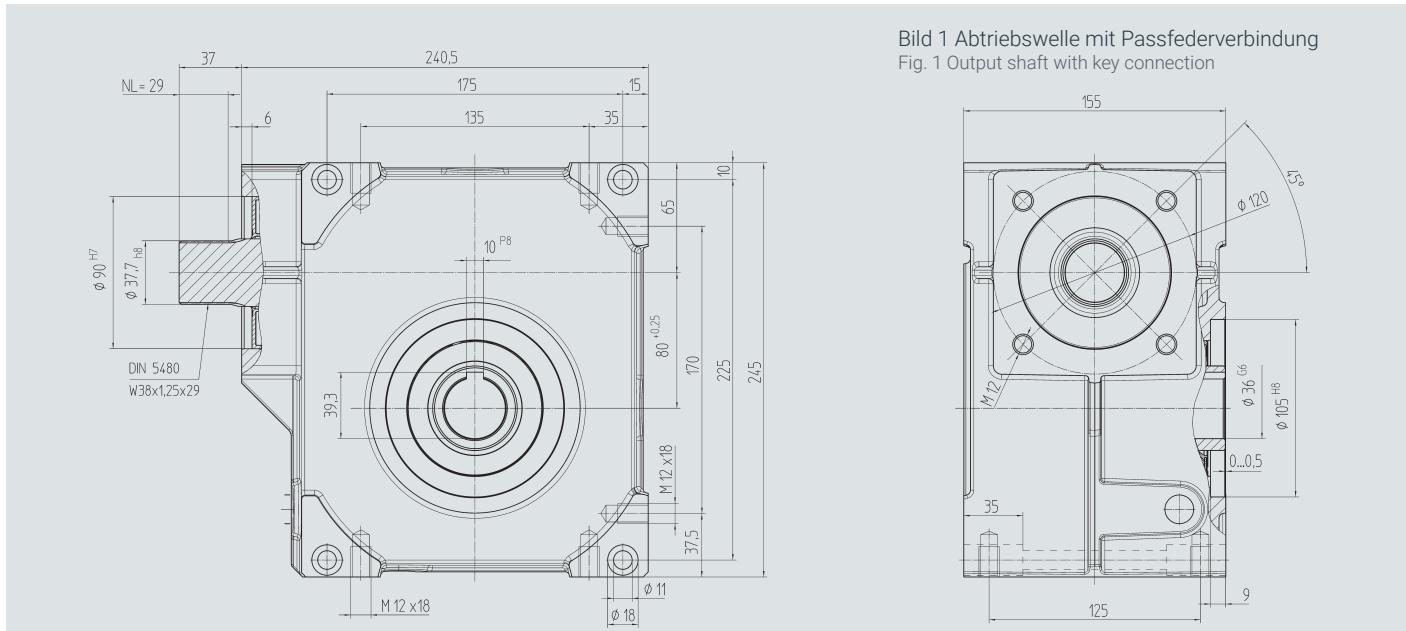
Bild 1 Abtriebswelle mit Passfederverbindung
