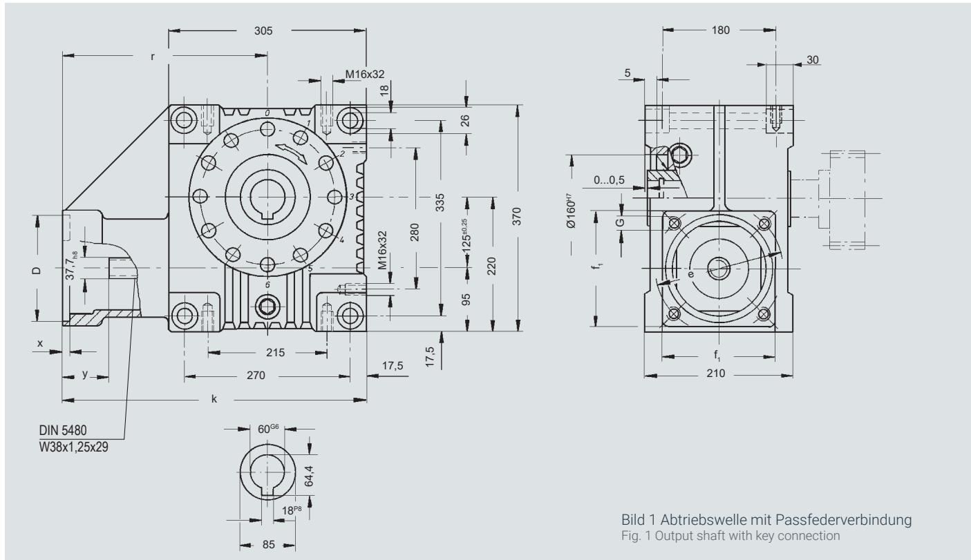
Bild 1 Abtriebswelle mit Passfederverbindung
