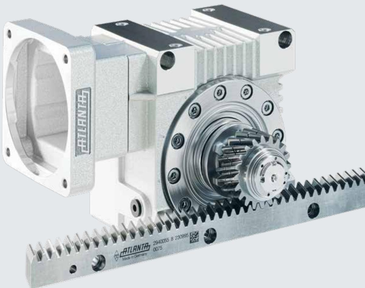
**schräg verzahnt, 19° 31' 42" links, 20° EW, Verzahnung geschliffen, Toleranz nach DIN 3962/63/67**
