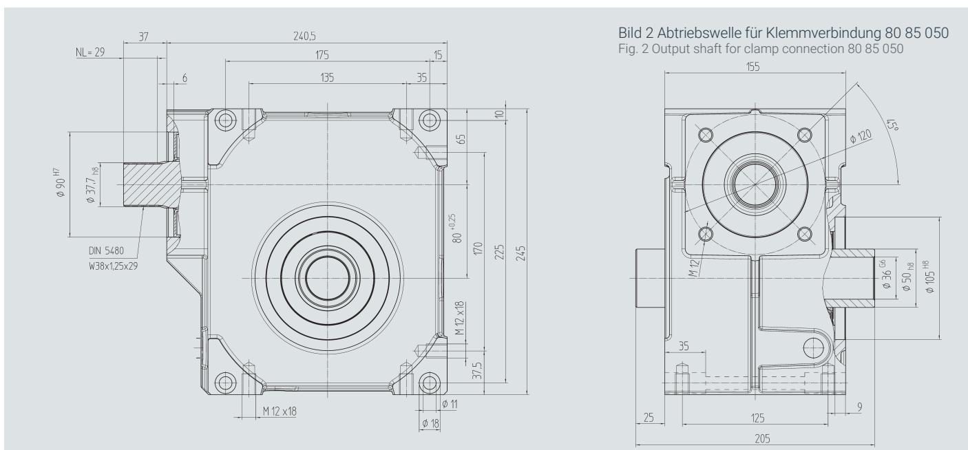
Bild 2 Abtriebswelle für Klemmverbindung 80 85 050
