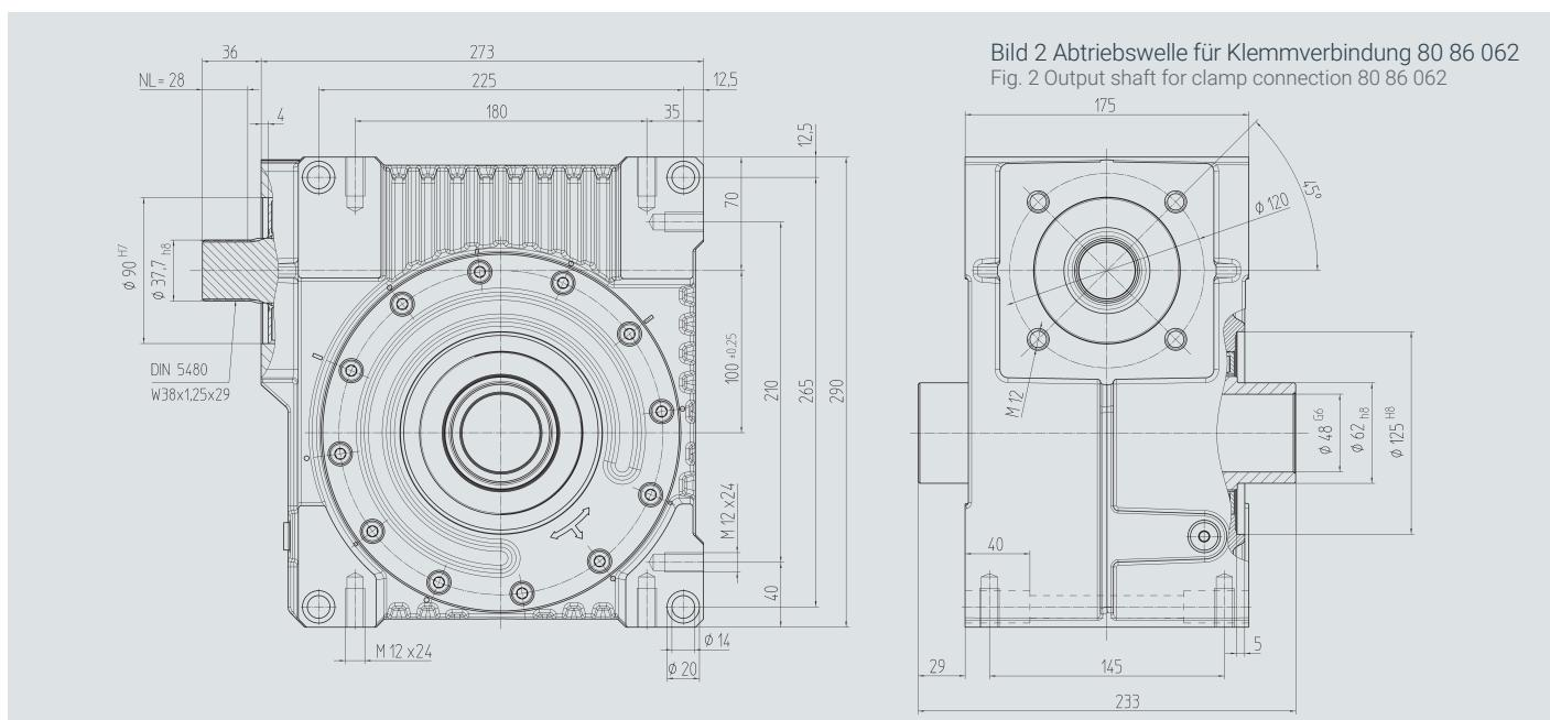
Bild 2 Abtriebswelle für Klemmverbindung 80 86 062
