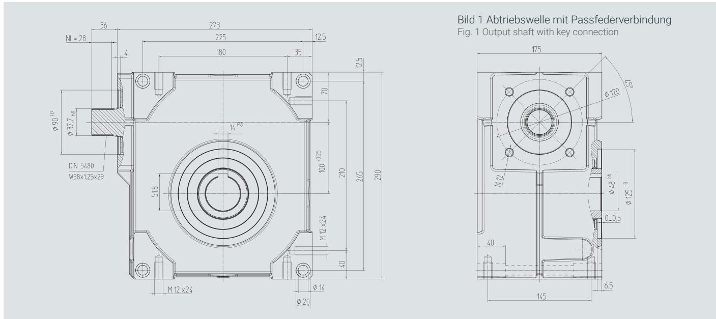
Bild 1 Abtriebswelle mit Passfederverbindung
