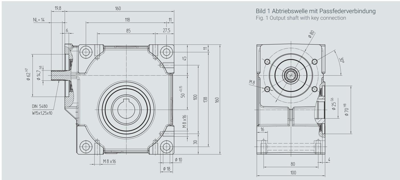
Bild 1 Abtriebswelle mit Passfederverbindung
