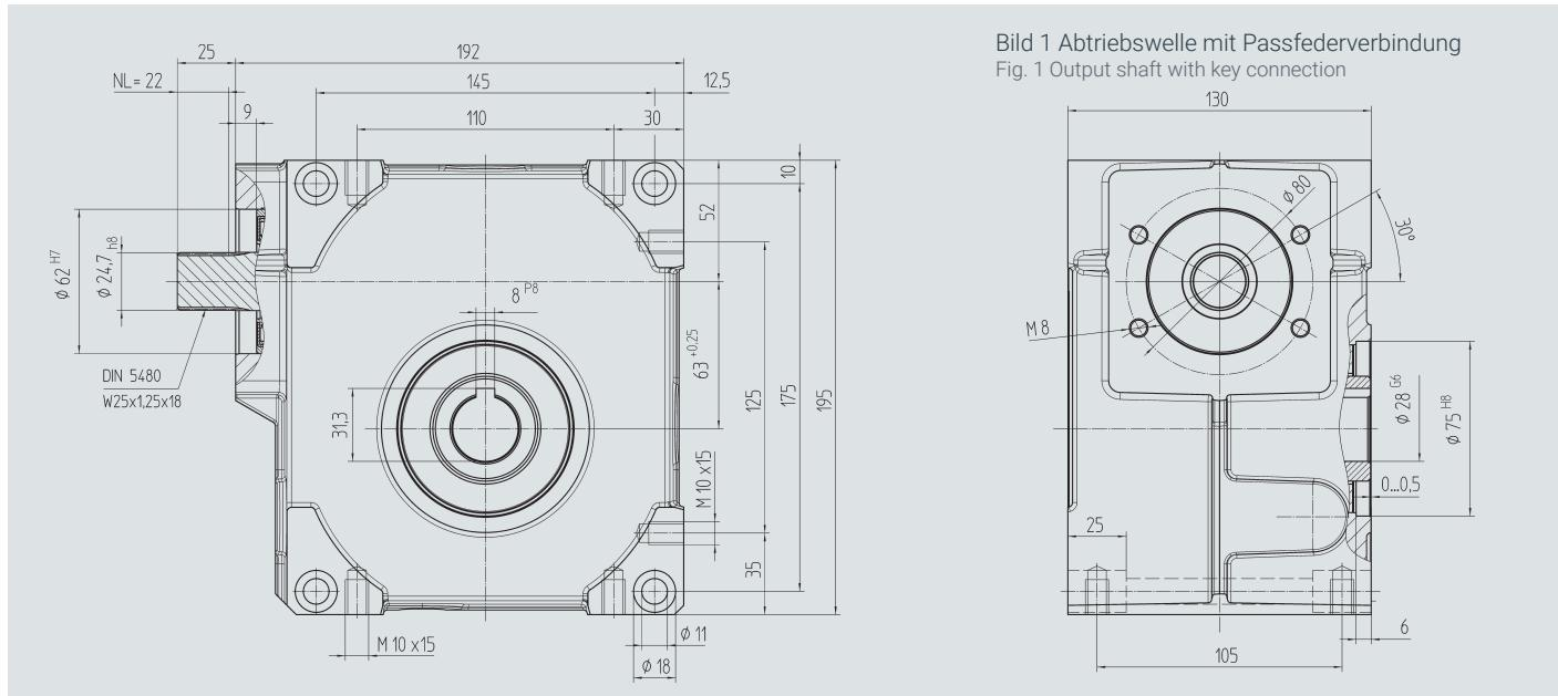
Bild 1 Abtriebswelle mit Passfederverbindung
