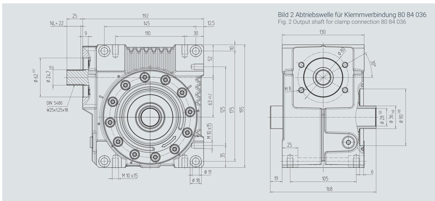
Bild 2 Abtriebswelle für Klemmverbindung 80 84 036
