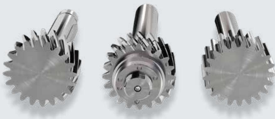
**gerade verzahnt, 20° EW, Verzahnung längsballig geschliffen, Toleranzen nach DIN 3962/63/67**
