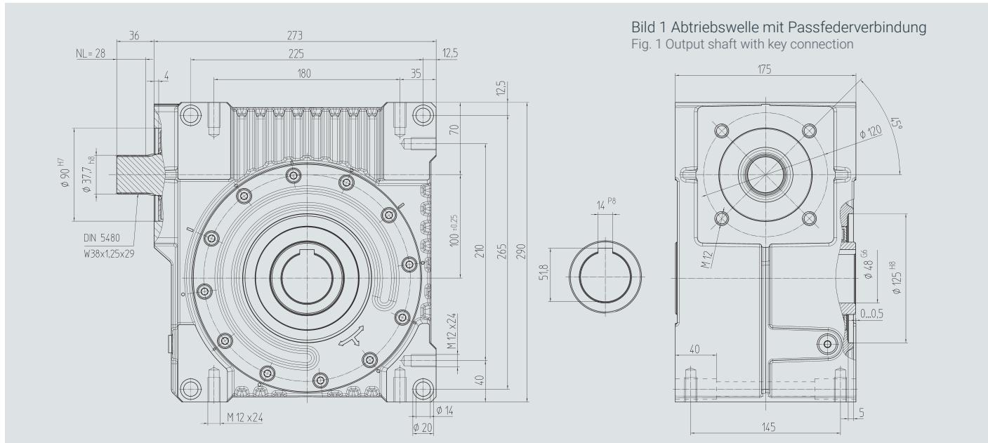
Bild 1 Abtriebswelle mit Passfederverbindung
