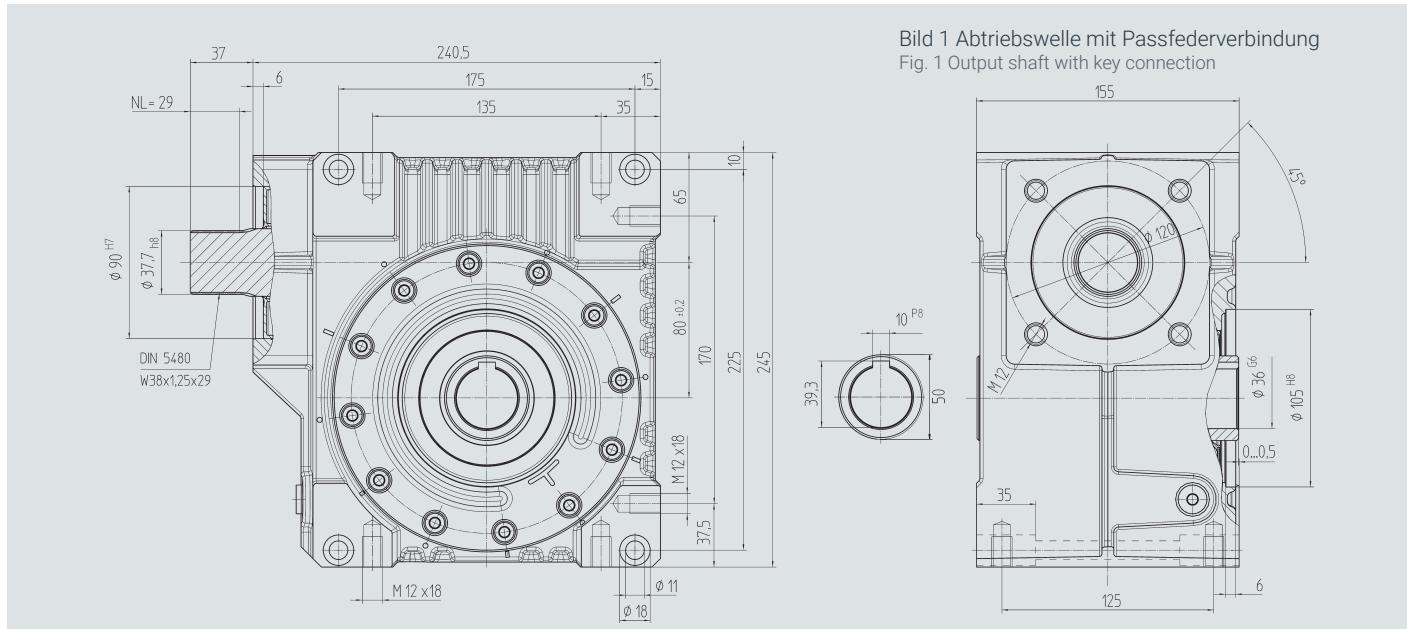
Bild 1 Abtriebswelle mit Passfederverbindung
