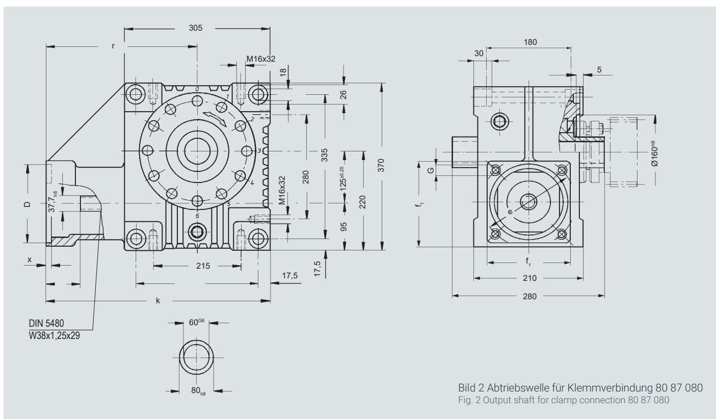
Bild 2 Abtriebswelle für Klemmverbindung 80 87 080
