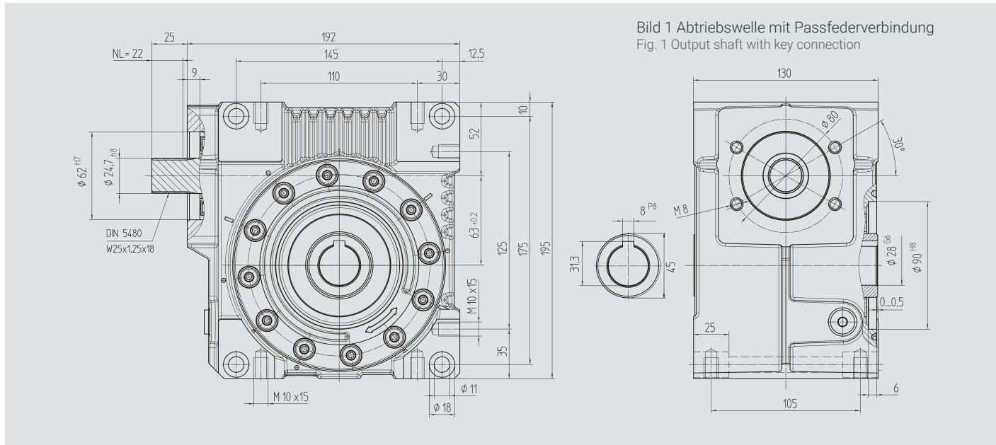
Bild 1 Abtriebswelle mit Passfederverbindung
